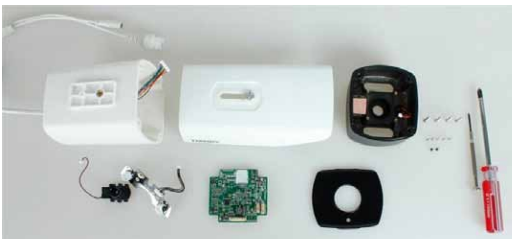
La telecamera Tiandy ha pochi componenti, facile da assemblare.
