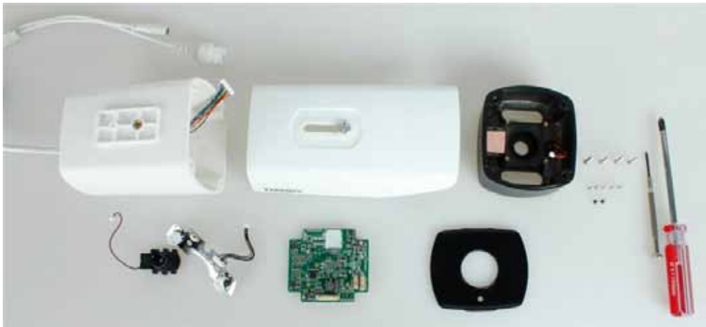
La telecamera Hikvision non ha molti componenti, ha molte viti, lo smontaggio è facile.
